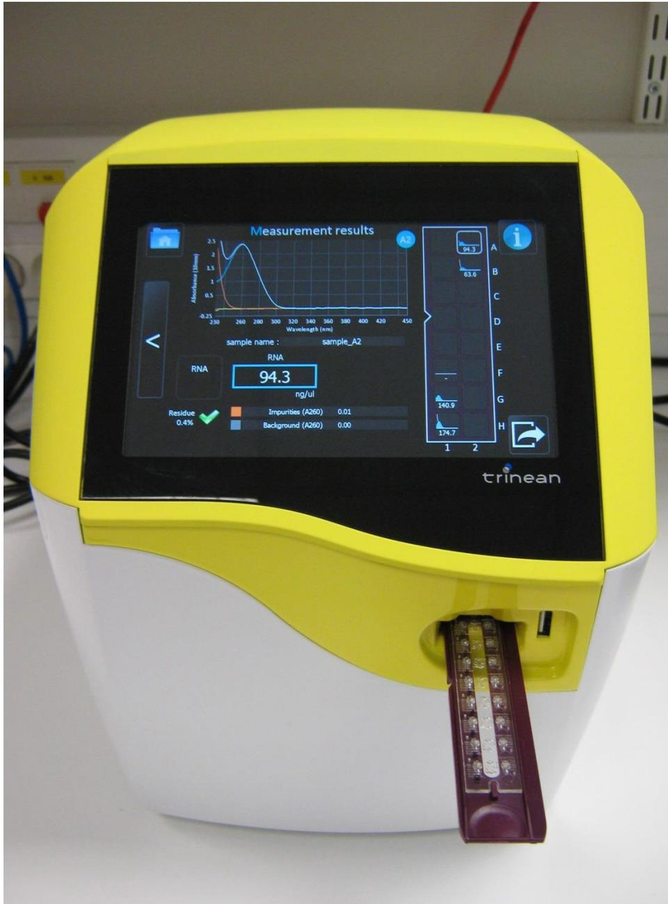
Ces tests ont été effectués pour valider le Xpose dans des conditions de contaminations par les composants des tampons les plus utilisés (Tris, EDTA, Ethanol), ceux des protocoles d'extraction (Qiazol) et par l'ADN génomique. Les échantillons contaminés ont été passés également sur notre NanoDrop 2000 afin de les comparer.
